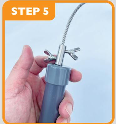
鎖緊水管後端鎖制件上的蝴蝶螺絲。
