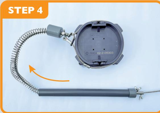
拉水管往踏板方向，將彈簧續壓進入水管中。
