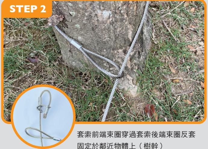
套索前端束圈穿過套索後端束圈反套固定於鄰近物體上（樹幹）
