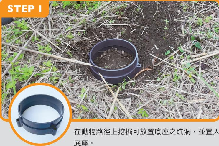
在動物路徑上挖掘可放置底座之坑洞，並置入底座。
